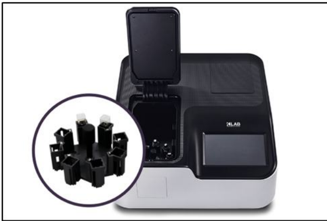
[그림 1]. Alpha UV-Vis 분광광도계 - 190-1,100 nm 파장 범위에서 동작하는 더블빔(double-beam) UV-Vis 분광광도계로, 정밀한 흡광도 측정과 정량 분석에 적합하다. 멀티셀 홀더 등 다양한 셀 홀더 옵션과 호환되어 다수 시료의 연속 측정이 가능하며, 본 연구에서는 ISO 14502-1에 따른 총 폴리페놀 분석을 위해 765 nm에서 시료의 흡광도를 측정하였다.
