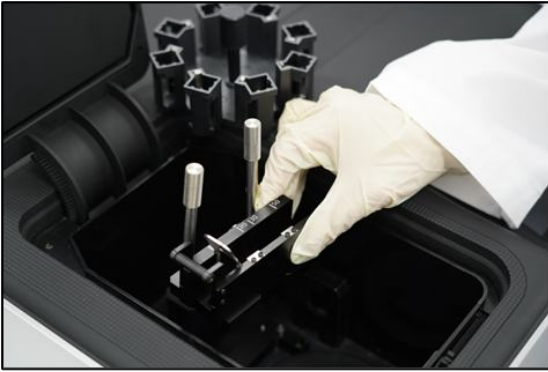
[그림 3]. Alpha UV-Vis 분광광도계의 셀 홀더 교체 모습 - Alpha는 공구 없이 홀더를 분리·결합할 수 있도록 설계되어 있으며, 교체 시에도 기계적 기준점이 유지되도록 제작되어 있다.
