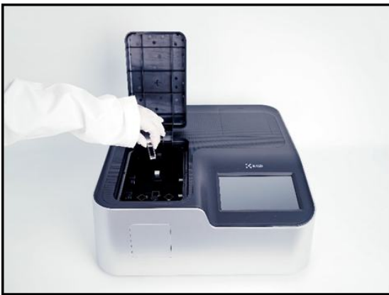
[그림 1]. Alpha UV-Vis 분광광도계 - K LAB에서 개발한 더블빔(Double-Beam) UV-Vis 분광광도계로, 190-1,100 nm 파장 범위를 지원하며 올리브유의 K_{232} 및 \Delta K 값 계산에 필요한 자외선 영역 데이터를 안정적으로 제공한다
