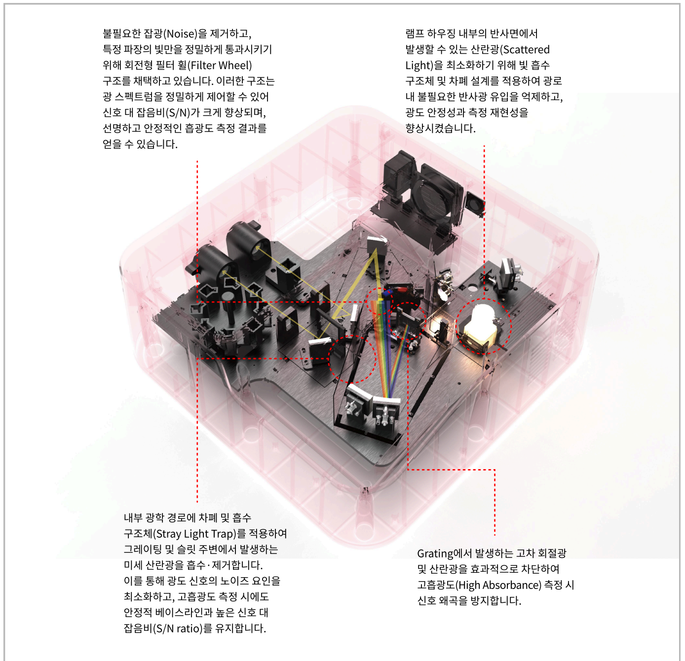
[그림 2]. Alpha UV-Vis Spectrophotometer의 Stray Light 차단 설계 구조 - 램프 하우징, 회절격자, 광학 블록 등 주요 광로 구간에 차폐 구조와 빛 흡수 구조체를 적용하여, stray light를 0.05% 이하로 억제한다. 이를 통해 고흡광도(High Absorbance) 측정 시에도 신호 왜곡을 방지하고, 높은 신호대잡음비(S/N ratio)를 유지할 수 있다.
