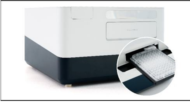
[그림 1]. MRX 마이크로플레이트 리더기 - MRX는 내장된 엔도톡신 모드를 통해 \pm 0.5^{\circ}\text{C} 정밀도의 37^{\circ}\text{C} 인큐베이션 기능을 제공하며, 96-well plate를 8초 이내에 빠르게 판독할 수 있다. 실시간 데이터 확인과 자동 보고서 생성 기능을 갖추어 효율적이고 정밀한 내독소 분석이 가능하다.
